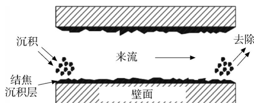
图 11 光滑管路内结焦过程 [25]
